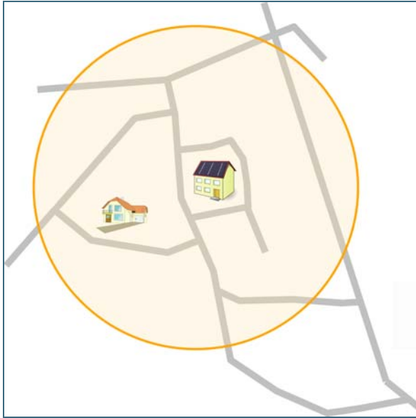
Abb. 5: Kritische Immissionsorte liegen meist westlich oder östlich einer Photovoltaikanlage und weniger als ca. 100 m von dieser entfernt.
